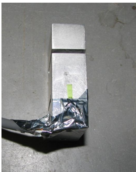
Figura 4 - Strain gage colado ao bloco de alumínio.
