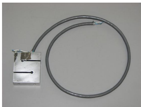
Figura 5 – 1ª célula de carga - bloco de alumínio + strain gage + cabo.
