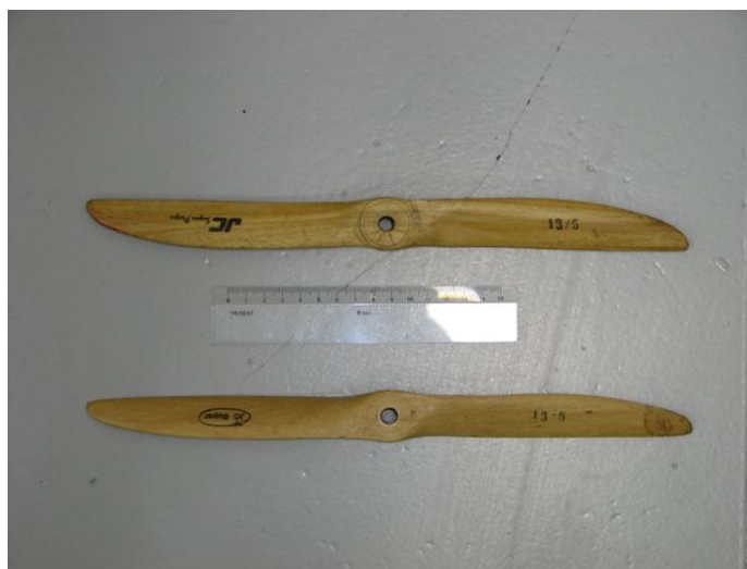
Figura 18 - Hélices utilizadas - 13/5 (acima) e a 13/8 (abaixo)
